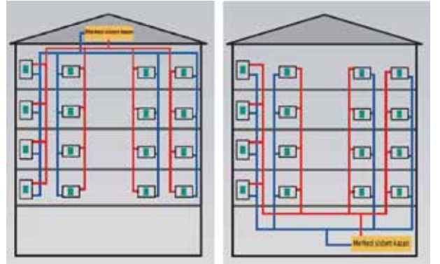
Şekil 1. Merkezi ısıtma sisteminin şematik görünümü
